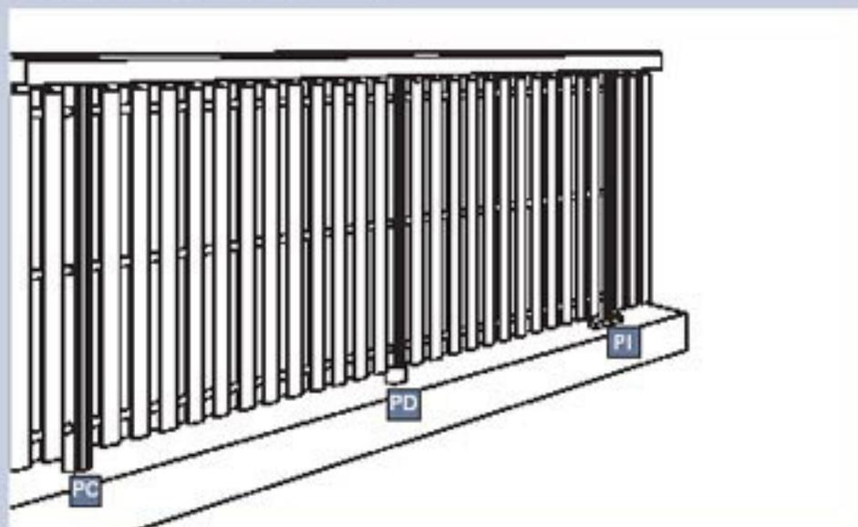
Nell'applicazione sopra soletta, il parapetto viene posto in opera sulla soletta del balcone ed il fissaggio dei montanti (completi di staffe PC, PI o di tazza PD) avviene mediante tasselli meccanici, con adeguato trattamento antinfiltrazione.
