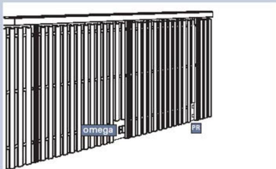
Nell'applicazione fronte soletta, il parapetto viene posto in opera sul frontalino della soletta stessa ed il fissaggio dei montanti (PR o con staffe omega) avviene mediante tasselli meccanici.
